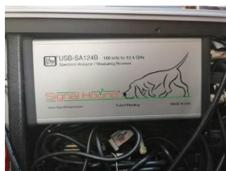
Рисунок 2 – Модуль анализатора спектра USB-SA124B (100 кГц-12.4 ГГц)
